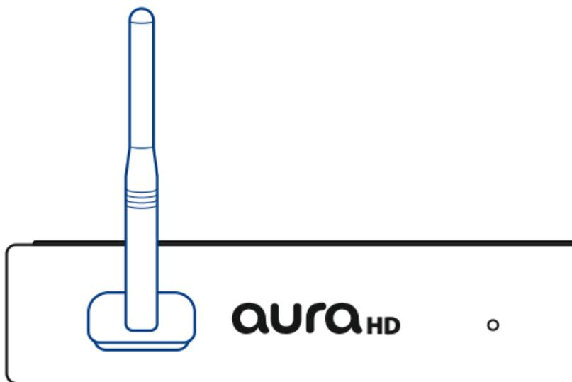
Для беспроводного подключения мы рекомендуем подключать WiFi-адаптер в USB-разъем на передней панели устройства.
