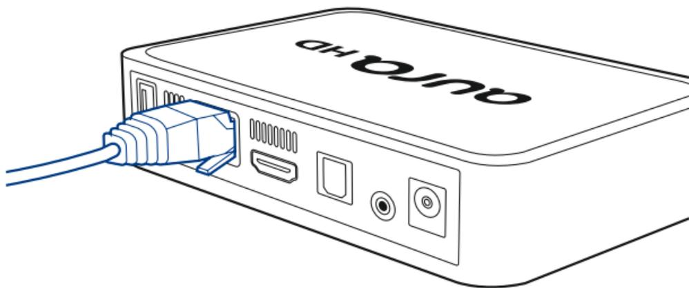
LAN-разъем для проводного подключения находится на задней панели медиаплеера.
